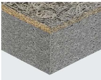
Pannello isolante termico ed acustico composito, costituito da uno strato (spessore 10 mm) in lana di legno di abete rosso mineralizzata e legata con cemento Portland grigio, accoppiato ad uno strato di polistirene espanso sinterizzato additivato con grafite, conforme alla norma UNI EN 13163.
